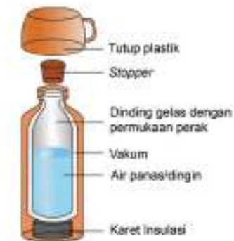
Gambar 6.21. Bagian-bagian termos sumber : Alvius Tinambunan/Kemendikbudristek (2022)
