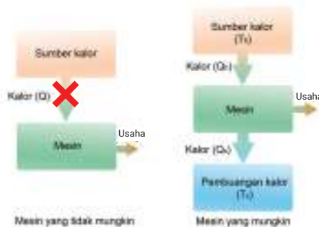
Gambar 7.28 Kerja mesin berdasarkan Pernyataan Kelvin-Planck sumber : Alvius Tinambunan/Kemendikbudristek (2022)
