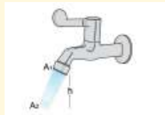
Gambar 4.21 Prinsip Bernoulli pada keran air sumber : Alvius Tinambunan/Kemendikbudristek (2022)
