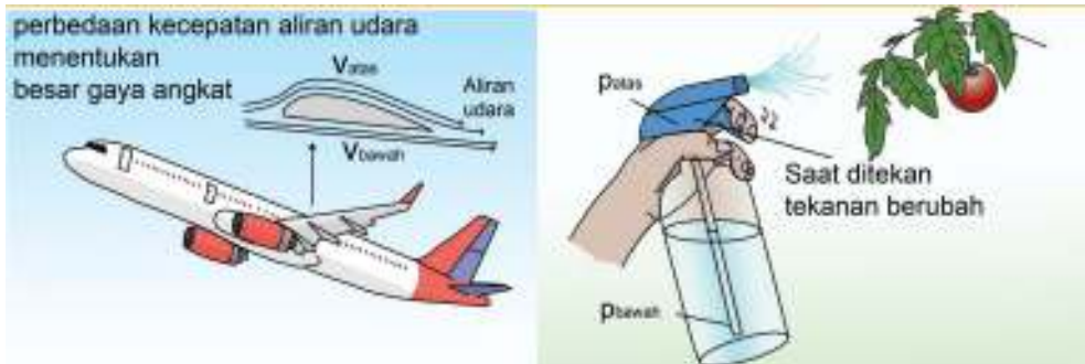
Gambar 4.25 Prinsip Bernoulli pada pesawat dan sprayer sumber : Alvius Tinambunan/Kemendikbudristek (2022)
