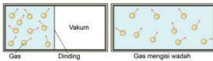
Gambar 7.4 (a) Sebelum ekspansi gas dan (b) Sesudah ekspansi gas sumber : Alvius Tinambunan/Kemendikbudristek (2022)
